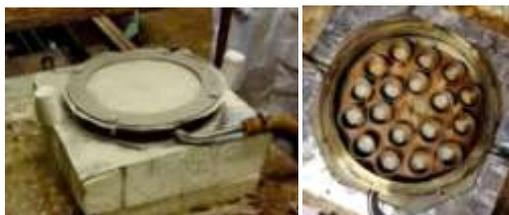
Рис. 3. Вакуумная климатическая камера для облучения электронами.
